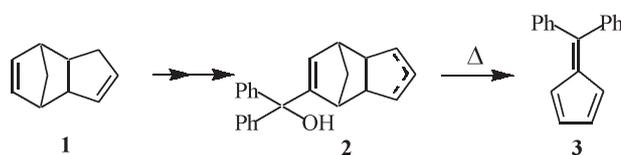
この熱分解反応の方法については、適当な付加物を加えた有機溶媒中での加熱を中心に行ってきた。この方法は特殊な装置も必要なく、通常の実験室で行うことが可能であり、また技術的にも比較的容易だと考えられる。ここで、付加物としては、クロマトグラフィーでよく用いられるシリカゲル、アルミナ、およびフロリジルと、また脱水能力の大きい無水硫酸銅を使用した。有機溶媒としては、沸点が180℃以上のデカリン、 $\alpha$ -ジクロロベンゼン、*N,N*-ジメチルアニリン、キノリン、フタル酸ジメチルを用いて熱分解反応を行ってきた。その結果、キノリン-シリカゲル、 $\alpha$ -ジクロロベンゼン-無水硫酸銅の結果が比較的良いものであったが、収率は50%を少し超える程度であり、さらなる検討が必要であると思われる。また、付加物と有機溶媒の組み合わせによって、収率が大きく異なることも明らかになっている。
