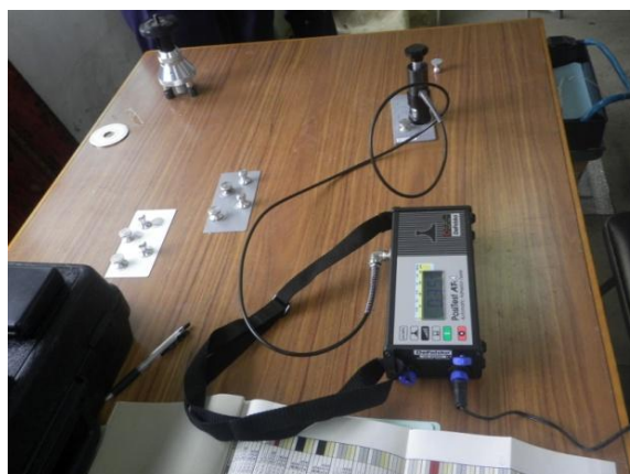
図 5-9 付着力試験の実施状況
