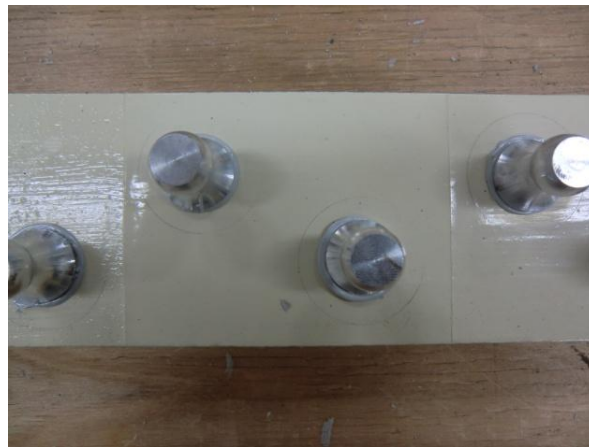
図 5-8 塗装面へのドリリー接着状況
