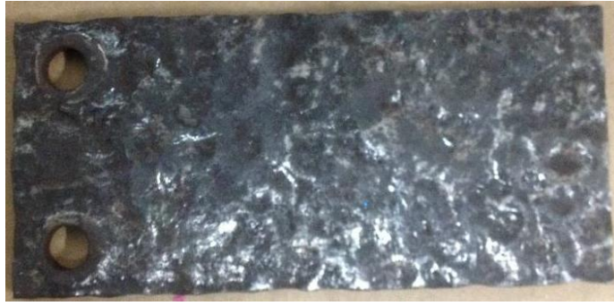
図 4-14 さび除去後の暴露試験片
