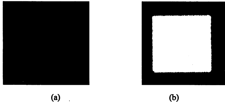
図1 コピー用紙全面を黒く印刷した試料(a) に最適なエネルギー条件でレーザを照射した場合(b)
