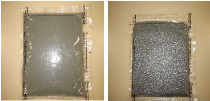
図-3 袋状構造の試料の外観 (左：脱気無し，右：脱気密封)
