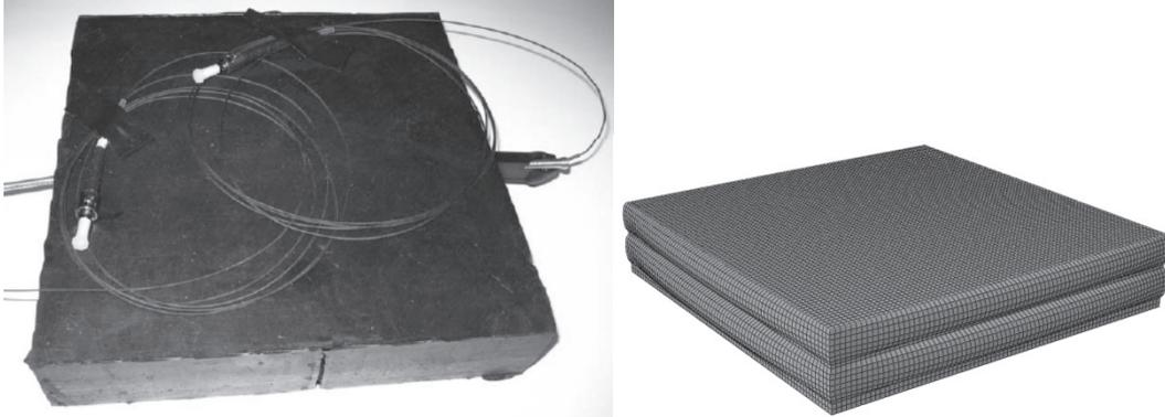
Fig. 1 センサ埋め込みゴム支承（左）と、圧縮力を受け変形するゴム支承の有限要素モデル（右）
