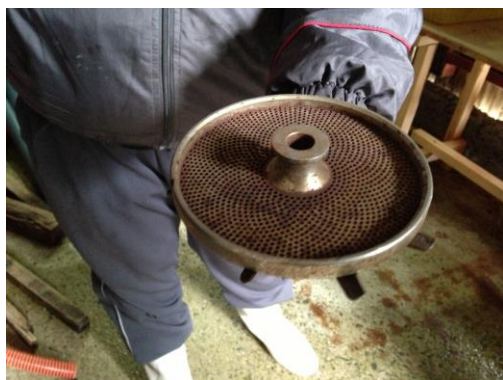
写真7 ノリを裁断するミンチ穴(小) (2013年12月21日, 山下撮影)
