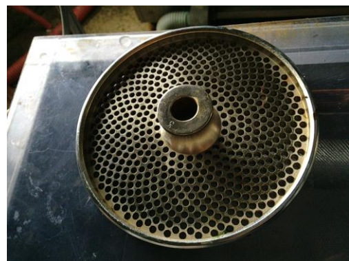
写真6 ノリを裁断するミンチ穴(大) (2013年12月21日, 山下撮影)
