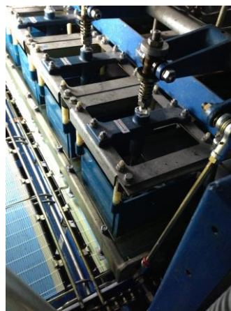
写真8 海苔の成型工程 (2013年12月21日, 山下撮影)
