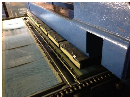
写真9 海苔の脱水工程 (2013年12月21日, 山下撮影)
