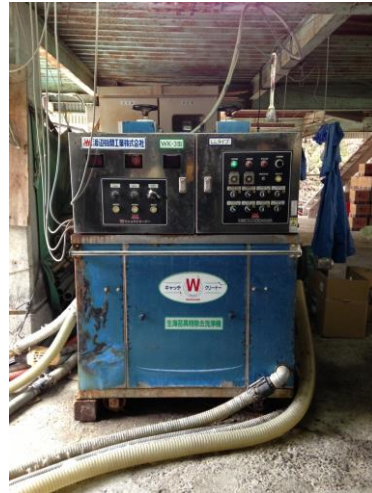
写真4 生ノリ異物除去洗浄機① (2013年12月21日, 山下撮影)
