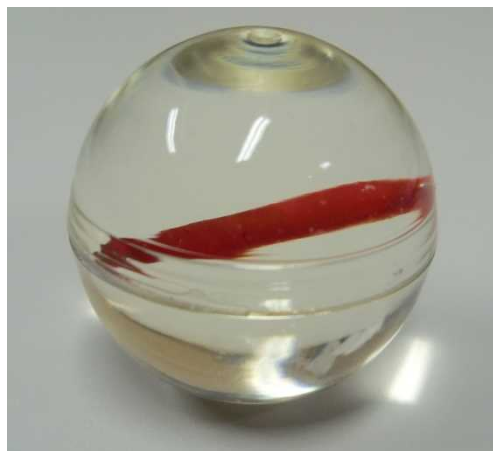
図 2 鉄針を油とともに球形カプセルに固定・封入した回転鉄針
