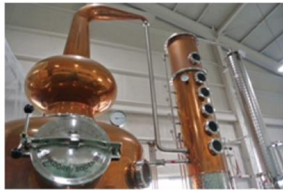
写真2 宮下酒造のポットスティル (ジンを蒸留) (2016.9.16. 寺岡撮影)
