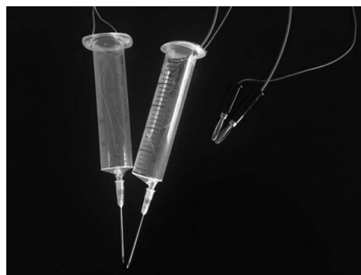
図8 作製した探針の全体図
