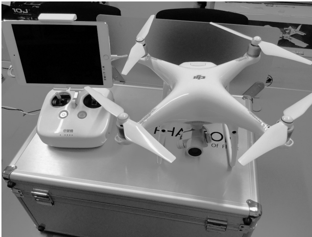
図2 本研究で使したUAVの外観。Phantom 4 proとカメラからの映像を確認したり航路を設定するためのタブレット端末。
