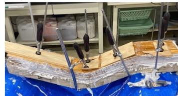
Fig.7 接着剤を塗布し、木型にはめ込んだ積層フレーム続いて、加工し完成したマルチバイクを Fig.8 に示す。
