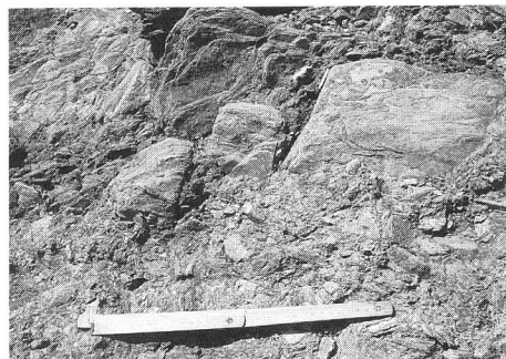
図-6 片理や節理の割れ目に充填する角礫岩
