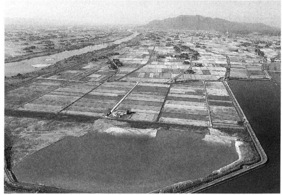
第4図 宍道湖西岸の出雲空港延長に際し、治水面積を減らさないために掘削された斐伊川河口左岸の干拓地 （1986年10月、建設省出雲工事事務所撮影、提供）
