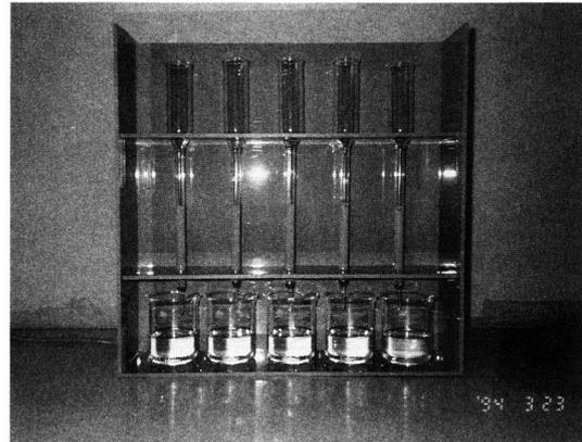
第1図 Rb, Sr および希土類元素分離用イオン交換塔 (カラム)。白い部分はイオン交換樹脂の充填されている部分。樹脂の高さは10cm。
