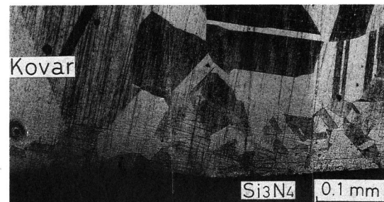
(b) コバルトがセラミックスと接合されなかった界面
