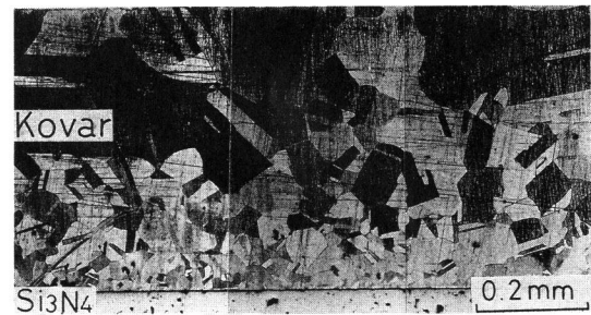
(a) コバルトがセラミックスと接合された界面
