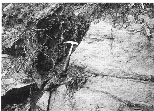
写真-6 節理面と片理面上に載る崩積土
