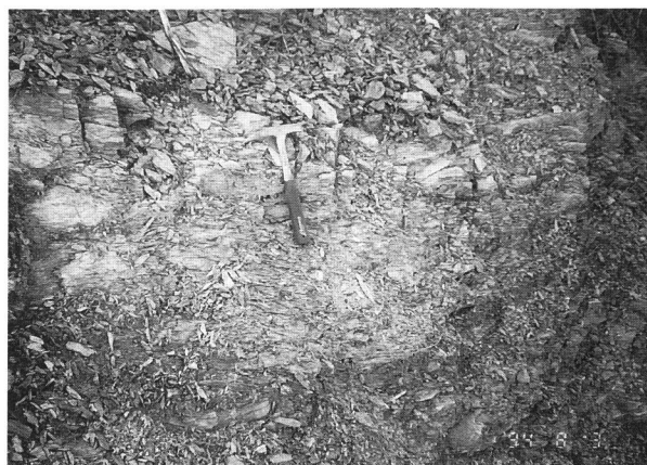
写真-5 緑色岩の風化、一部赤褐色の粘土化
