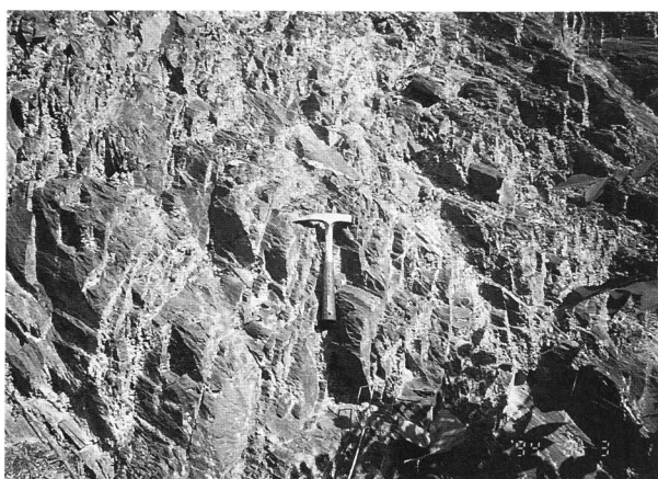
写真-8 微褶曲する緑色岩の節理面と片理面
