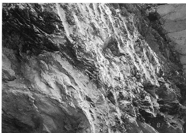
写真-4 写真-3中の剪断帯
