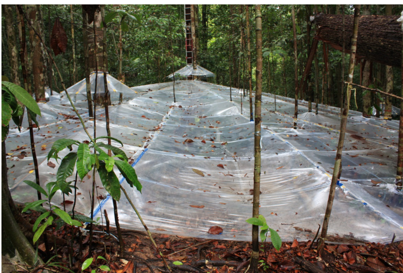
図 5-1 降水遮断装置側面部の写真
