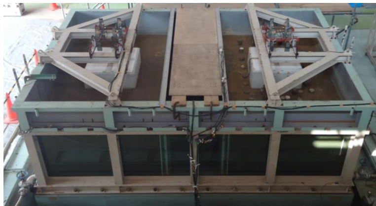
写真-2 加振前の大型土槽全景
