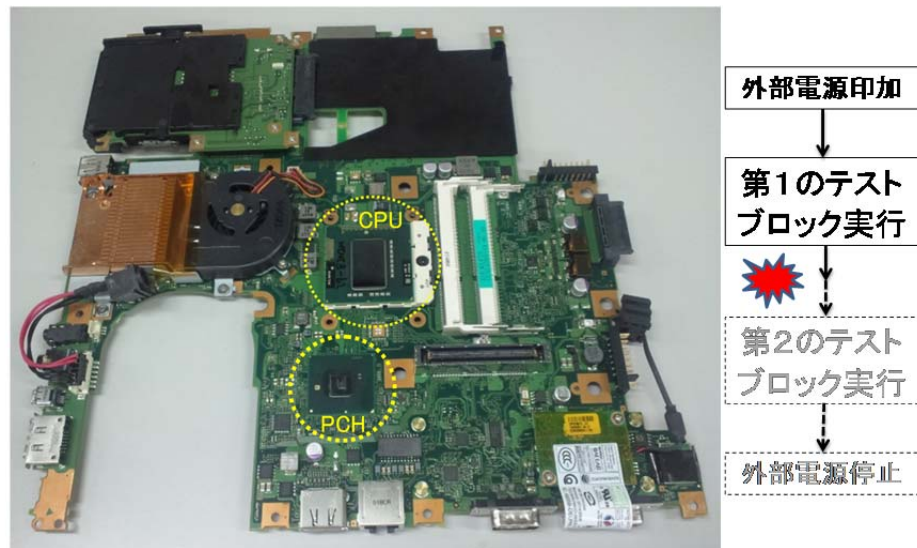
図 5-8 実験に使ったパソコンのマザーボード
